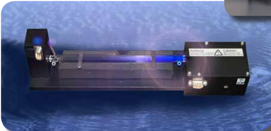
Die "Seele der Maschine": Die optische Bank im VM-3000
